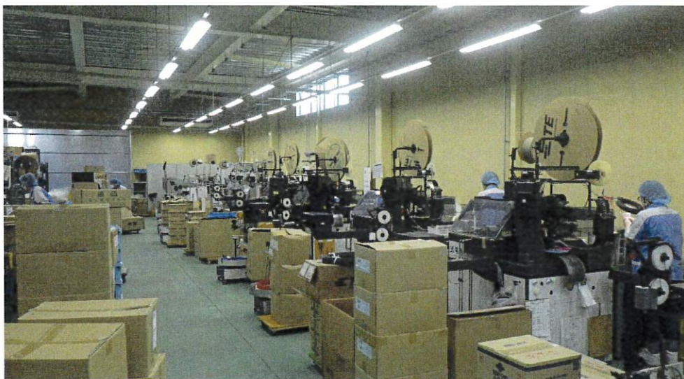
●自動切断圧着機（新明和製）12台 ※協力工場7台
